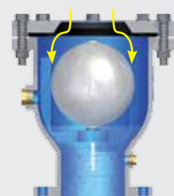
Admisión de grandes cantidades de aire durante el vaciado
