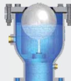
La válvula permanecerá cerrada hasta que se detecte una depresión en la conducción
