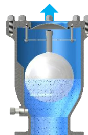
Purga de aire en carga
