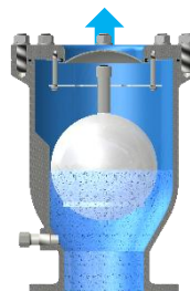
Purga de aire en carga
